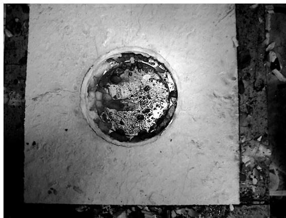
Figura 1. Molde de fisuración
