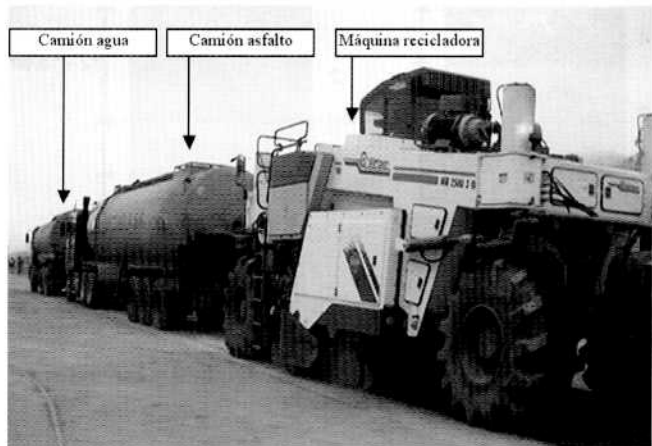
Figura 8. Fotografía del tren de reciclado utilizado en el proyecto de rehabilitación
