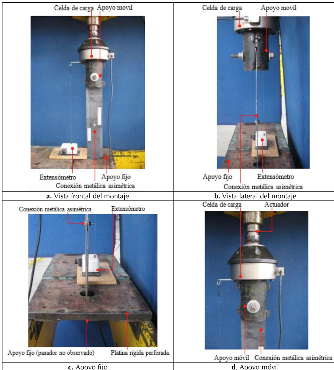
Figura 2. Montaje del ensayo de la conexión
